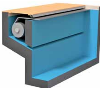
Vano adiacente alla vasca con separazione in muratura
